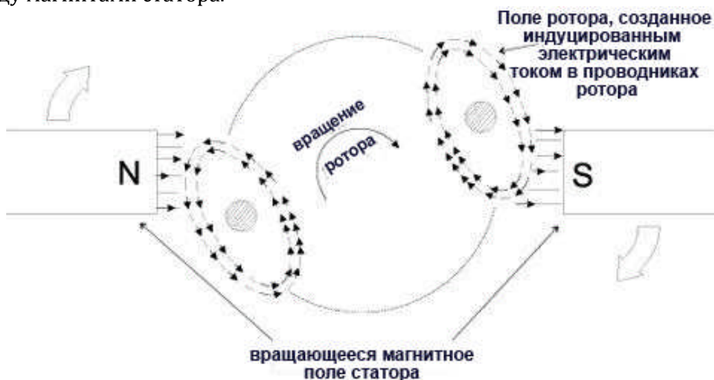
Схема движения внутри электромагнитного мотора
