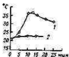
Рис. 10.1. Повышение температуры порошков магния (1) и алюминия (2) при добавлении к ним воды
