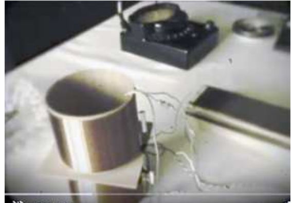
Рис. 9-8-18. КПЕ из жести от консервной банки с подключённым измерителем ёмкости Первый КПЕ (Конденсатор Переменной Емкости) я изготовил из жести от консервной банки. Экспериментируя с катушками, конденсаторами и германиевыми диодами, мне удалось получить странный эффект.
