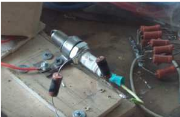
Рис. 3-0-27. Последовательно со свечой дабавил сопротивления. Без них перегорает диод и предохранитель. От нагрева сопротивления нагрелись, перегорели и даже распаялись. Потом сделал 13 сопротивлений 1,8мОм, мощностью 2 ватта, включены параллельно. Эти сопротивления не перегорели. Но лампы не загорелись.
