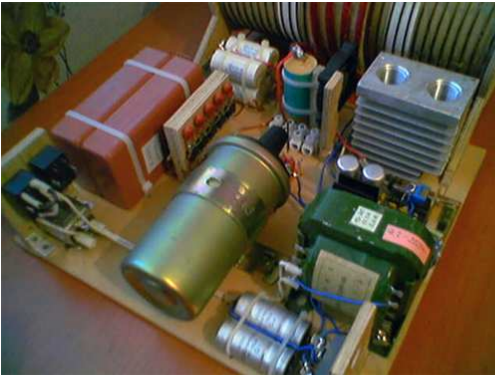
Рис. 3-9-6. Внешний вид устройства на основе катушки зажигания.
