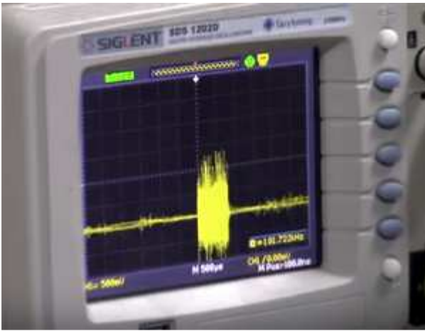
Рис. 8-4-5. Осциллограмма смещается в отрицательную зону.
