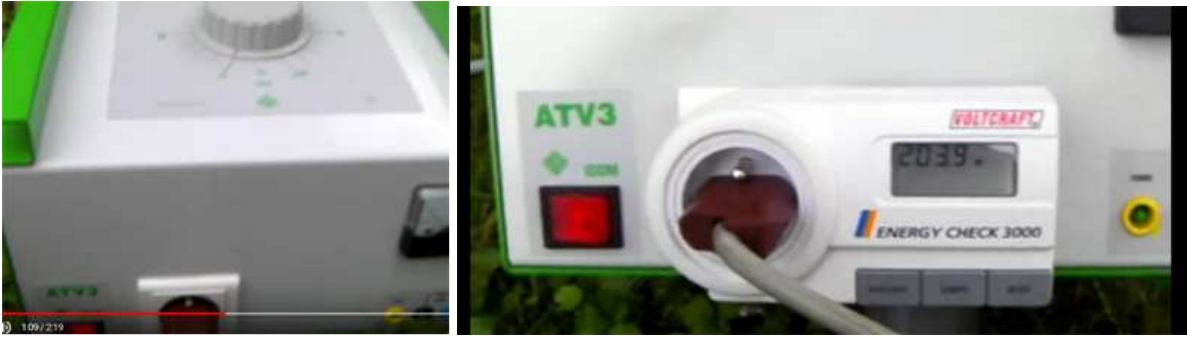
Рис. 3-0-5. апуск генератора осуществляется от внешнего источника питания Variac ATV3. Контроль потребляемой мощности осуществляется с помощью прибора Voltcraft Energy Chek 3000.
