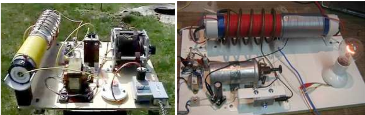
Рис. 6-3-1. Внешний вид генератора. Когда красная катушка (с сердечником) вводится внутрь синей катушки, то загорается лампочка. Когда красная катушка вводится без сердечника, то лампочка загорается очень слабо.
