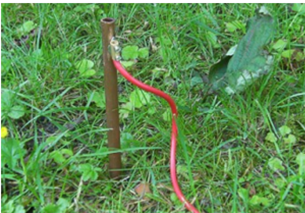
Рис. 3-0-3. Для правильной работы генератора требуется два заземления расположенные на расстоянии 10 метров, провода заземления имеют красный и зеленый цвет. Заземление красным проводом идет от катушки, а заземление зеленым проводом идет от лампы.
