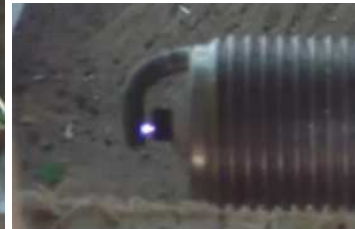
Рис. 3-0-26. В качестве разрядника используется свеча от Жигулей.
