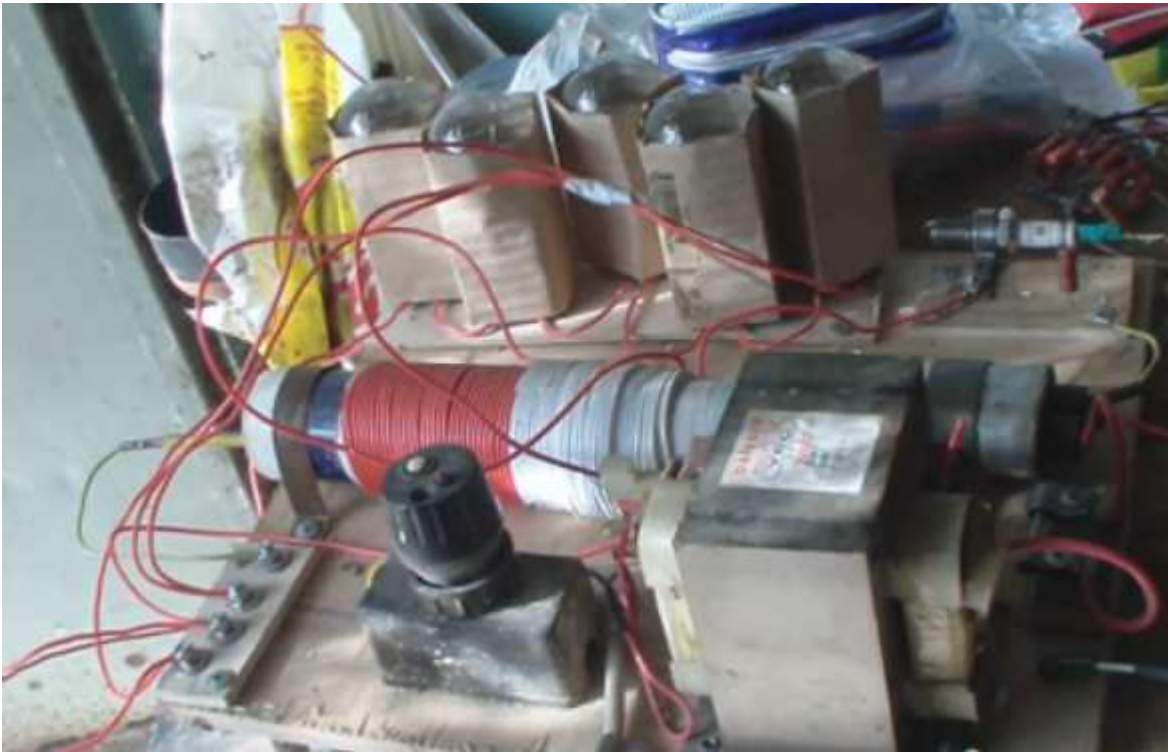
Рис. 3-0-25. Внешний вид генератора, конденсатор и диод от печки СВЧ. Катушку сделал сам.
